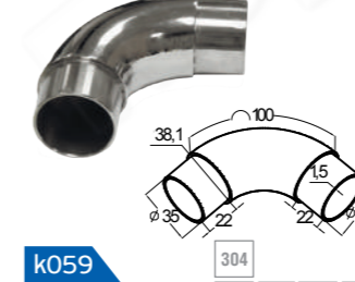
k059 k059-3 Отвод поручня под Ø38,1 x 1,5 мм, 90°, литой, с двумя установочными кольцами
