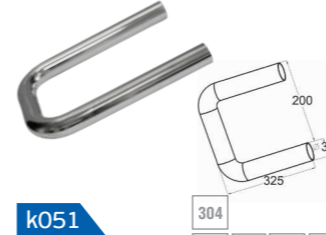
k051 k051-3 Оконч. поручня пандуса Ø38,1 x 1,5 мм, выпуски по 325мм для подгонки по месту до 300мм, 600GRIT
