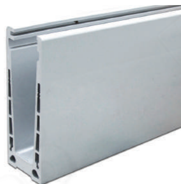
k601-5 Профиль алюминиевый зажимной 118x45 мм для несущего стекла 10-16 мм, анодированный, матовый, длина 6 метров, облегченный
