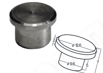
k265 304 P X Заглушка точеная под Ø12.7 x 1.5 мм, высота 7 мм
