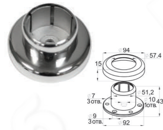
k220 304 P X Фланец с крышкой под трубу Ø50.8 мм, низ 90x10 мм. Основание литое, верх и цапга штамп.
