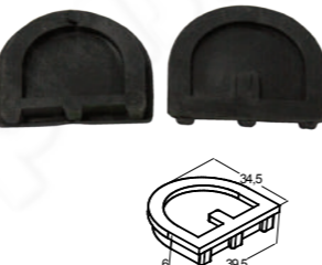
k218 Комплект резинок под стекло 8 мм, для стеклодержателей k038 и k039, 40x35x6.5 мм
