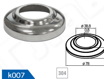
k007 k007-3 Низ стойки Ø38.1 мм, S=0.8 мм, внешний Ø78x12 мм, фигурный
