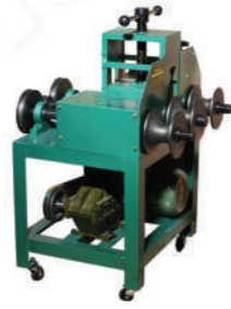
к938 Трубогиб трехваликовый мобильный, 1,5 кВт/220В, 730x630x1030мм (с валиками для прокатки круглых труб: 19, 22, 25, 32, 38, 51, 63, 76мм, для квадратных труб: 16x16, 20x20, 22x22, 25x25, 30x30, 40x40, 50x50мм).
