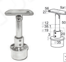
k317 304 P Наконечник стойки палец для Ø38,1x1,5мм, регул. по высоте и наклону, с ложе Ø50,8 мм
