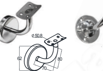
k010-4 201 P X Пристенок с ложементом под 50.8 мм, вынос 70x45, Ø60x3мм, сварной с крышкой 25x45x2 мм
