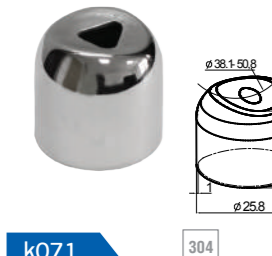
k071 304 P Наконечник прямой, на стойку Ø25,4 мм, с универсальным ложе для поручней Ø38,1+50,8 мм
