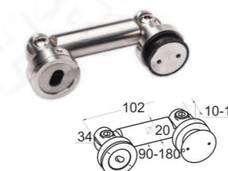
k641 Угловое крепление (90-180°) под стекло-стена 10-12 мм под зенковку (L=82 мм)
