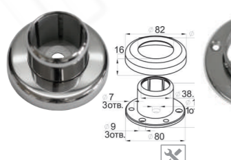
k026 304 P X Фланец с крышкой под трубу Ø38.1, низ 82x8 мм. Основание литое, верх и цапга штамп.
