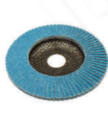
Φ-0695 Φ-1139 Шлиф. диск "лепесток" 125x22, циркониевое зерно, Клиншпор Φ-0695 P-60 (очень грубый сьем) Φ-1139 P-80 (грубый сьем)
