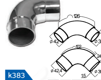
k383 k383-3 Отвод поручня под Ø38,5 или Ø42,4 x 1,5 мм, 90°, литой, с двумя установочными кольцами
