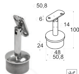
k042 304 P Наконечник палец регул. 65 мм, с ложементом, Ø50,8 x 1,5 мм
