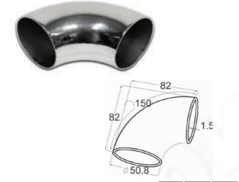
k021-5 Отвод поручня под сварку для Ø50,8 x 150 x 1,5 мм AISI 316, Удлиненный
