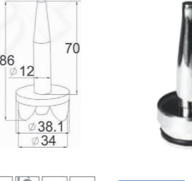
k041 304 P Нак. палец для Ø38,1 с резинкой, закручивающийся, без необх. варить к стойке, без ложе под поручень
