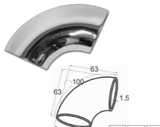
k095-4 Отвод поручня Ø38,1x1,45мм, 90°, 400 Grit AISI 316, очень полированный, 800 Grit
