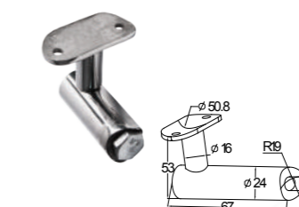
k243 304 P X Выносной держатель поручня на стойку 38.1мм, с ложементом, под 50.8мм, резьба внутр. M10
