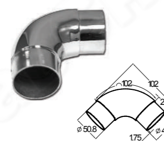
k052 Отвод поручня Ø50,8 x 1,5 мм, 90° с вставками для трубы, литой, тяжелый
