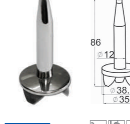
k034-2 304 P Наконечник "палец" для Ø38,1 x 1,5, вынос 70мм, без ложеента, конусный для облежения сварки
