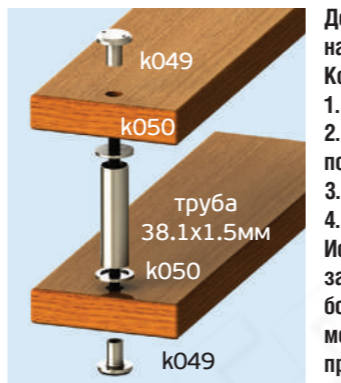
Детали для лестницы на больцах: Конструкция больца: 1. розетты k050 2шт 2. больцевая гайка k049 под шпильку M16, 2шт 3. шпилька M16 4. труба нерж. 38.1x1.5 Используя одноанкерную закладную вместо верхней больцевой гайки k049 можно установить проходную стойку д.38.1
