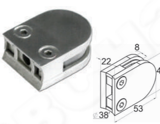
k001-5 Стеклодержатель литой с вставками под стекло 8 мм, закругленный под Ø38, 40x22x53, AISI 316
