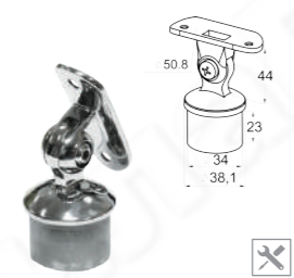
k327 304 P Наконечник шаровый для стойки Ø38,1x1,5 мм, регулируемый 44мм, с ложементом под Ø50,8 мм
