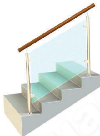
Ограждение со стеклом и стойками
