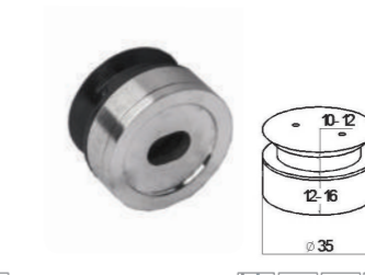
k645 Точечное крепление под стекло 10-12 мм, регулируемое 11.5-14 мм под зенковку
