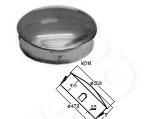
k014 304 P X Заглушка штампованная на трубу Ø50.8x1.5 мм, полированная
