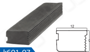
k601-07 Лицевая уплотнительная резинка 12x12 мм для стекла 15 мм или триплекса 6+6 мм
