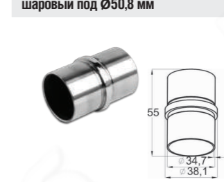
k086 Соединитель трубы Ø38.1x1.45мм, с насечками
