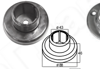
k334 304 P X Фланец с крышкой под трубу Ø42.4 мм, низ 90x10 мм. Основание литое, верх и цапга штамп.
