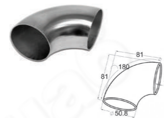
k021-11 Длинный отвод поручня Ø50,8 x 180 x 1,5 мм, длина 180мм, 400 Grit
