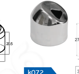
k072 304 P Наконечник под 30°, на стойку Ø25,4 мм, с универсальным ложе для поручней Ø38,1+50,8 мм
