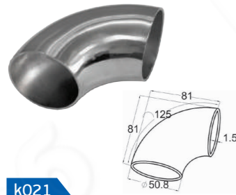
k021 k021-8 Отвод поручня под сварку для Ø50,8 x 125 x 1,5 мм, 400 Grit
