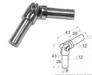
k357 Поворот ригеля Ø12x1 мм, с двумя установочными штифтами
