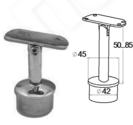
k372 304 P Наконечник стойки палец, Ø42,4 мм, с ложементом под поручень Ш50,8 мм
