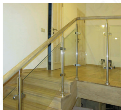
Ограждение лестницы и площадки со стойками K724 с литыми стеклодержателями, прозрачным стеклом 8мм и поручнем Ø49мм из дуба.
