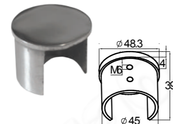
k235 304 P X Заглушка для поручня Ø48.3 мм с пазом 27x30 мм под стекло, полированная
