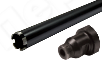
к411 Алм. коронка Ø56, Н=300 мм, резьба наружная, болт 1/2", для сверл. отверст. под стойку 40x40мм
