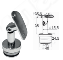
k204 304 P Наконечник палец Ø38,1 с резин., закручивающийся, без необх. варить, рег., с ложе Ø50,8 мм
