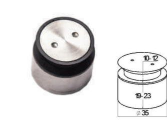
k647 Точечное крепление под стекло 10-12 мм, регулируемое 18.5-24.5 мм под зенковку
