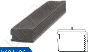
k601-06 Лицевая уплотнительная резинка 18x12 мм для стекла 10 мм
