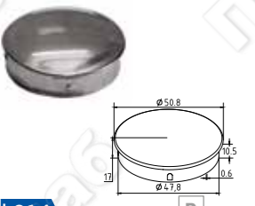
k014 k014-2 Заглушка штампованная на трубу Ø50.8x1.5 мм, полированная, шлифованная
