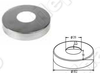
k201-5 201 P X Низ стойки Ø38.1 мм, 102 x 18 x 0,5, полированный (AISI 201)
