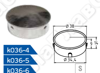
k036-4 k036-5 k036-6 k036-8 Заглушка под трубу Ø38x1.5, 0.6 мм сферическая
