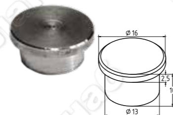
k040-3 Заглушка точеная под трубу Ø16x1.5 мм, высота 7 мм. AISI 304
