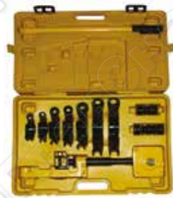
к914 Трубогиб ручной в пластиковом кейсе с роликами для трубы, 10, 12, 14, 16, 19, 22 и 25мм. 660x460x180мм. 25кг. R гнутья: 10-25мм
