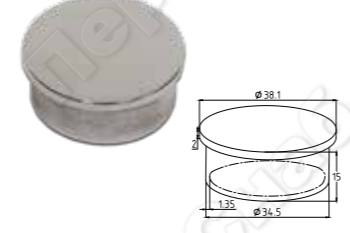
k093-4 Заглушка литая плоская Ø38.1 x 1.35 мм, полированная AISI 316
