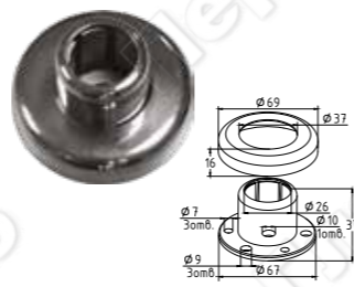
k343 Цанга под трубу Ø25.4 мм, низ 69x8 мм
