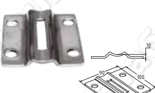
k056-4 Бок. крепеж пластина под стойку Ø38, вынос от стены 10мм, толщ. 3мм, сварка изнутри, без необх. зачищать шов AISI 304
