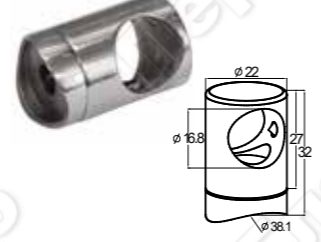
k018-4 Ригелдержатель на трубу Ø38,1 x 16,8 мм, AISI 316 , с потаем под вытяжную резьбовую заклепку
