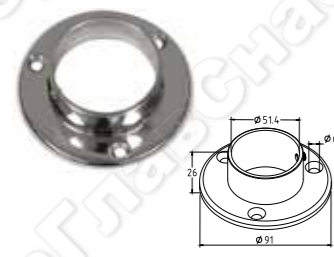
k022-6 304 P X Фланец настенный, для Ø50,8, под 3 самореза 4.8мм, 90x3мм, "Премиум", литой
