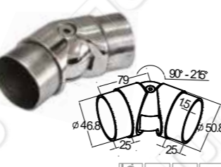
k011 Поворот литой, внутренний, регулируемый, 85+215°, под Ø50.8 x 1.5 мм
