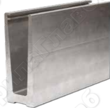
k601-3 Профиль алюминиевый зажимной 118x45 мм для несущего стекла 10-16 мм, не анодированный, матовый , длина 6 метров
