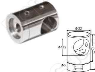
k029-3 Ригелдержатель под ригель 12мм на плоскость, полированный с отв. Ø13,5мм, для ригеля Ø12мм, литой, внеш Ø22, высота 30 мм
