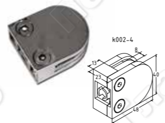
k002-4 Стеклодержатель литой, под стекло 8 мм, на плоскость 40x23x48 полированный (AISI 316)
