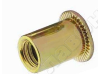
k478 Заклепка вытяжная M8, латунная, для уст. ригелдержателей без сварки (юбка прячется внутрь углубления)
