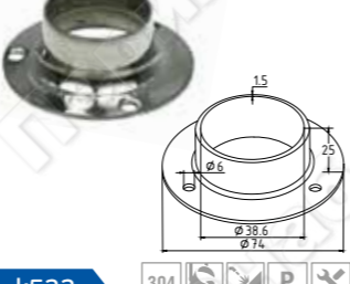
k533 304 P X Фланец штампованный для Ø38,1 мм, толщина 2 мм (AISI 304)
