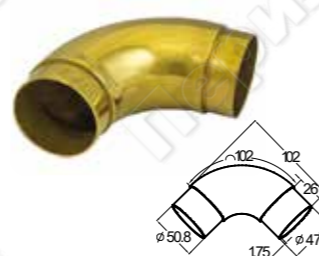
K052-88 Отвод поручня Ø50.8x102x1.45мм, 90°, полированный 600 Grit, с двумя установочными кольцами
