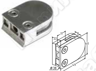
k001-5 Стеклодержатель литой с вставками под стекло 8 мм, закругленный под \varnothing 38 , 40x22x53, AISI 316
