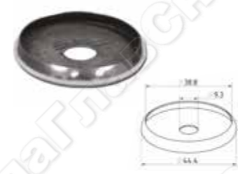
k097 201 P X Шайба подкладочная Ø38.1 мм, 44,5x3, с отверстием Ø9,3 мм (AISI 201)
